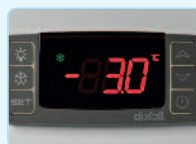
Thermostat électronique Affichage digital
